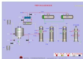
■ 甲醇车间自动控制系统
